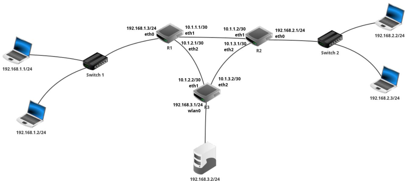
Figure 1: Un exemple de réseau
